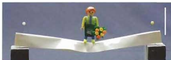
變形：沿縱軸線扭轉 - 低微的承重能力
